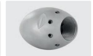
1" IG. 8x 75° +1x 0°. 100-250 l/min. Für \text{R} \varnothing 150-300 mm. Außen \varnothing 62 mm. \text{G} 1.265 g.
