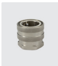
ST-45. Messing vernickelt. Kupplung : 3/4" IG. 25 bar / 90° C
