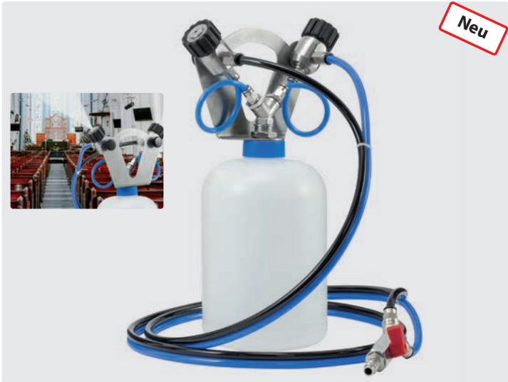
Desinfektions-Kalt-Nebelgerät ST-83.2. Für Druckluftanschluss 3 bar, 200-400 l/min. Edelstahl/PVC
