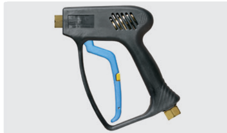
Professionelle Pistole. Weepausführung. Max. 275 bar / 45 l/min / 150 °C
