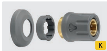
TR22 IG. Messing. Inkl. 2 Hitzeschutz-Abdeckkappen. Max. 400 bar / 150° C
