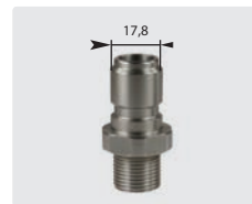
Stecknippel : AG. Edelstahl. 60° Dichtkonus. Max. 250 bar / 150 °C
