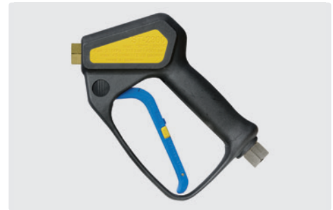
Professionelle Pistole. Weepausführung. Max. 310 bar / 45 l/min / 150 °C
