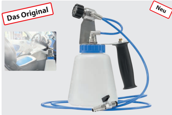
Desinfektions-Kalt-Nebelgerät ST-83.1. Für Druckluftanschluss 3 bar, 180-220 l/min. Edelstahl/PVC
