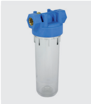
2-teilig. Entlüftungsstopfen. Innengewinde Messing. Max. 10 bar / 50 °C
