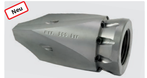
300 bar. 1" IG. \square 100 mm, \varnothing = 50 mm, \boxplus 0,64 kg. Für Rohre > 100 mm. Seitliche Frontstrahlen mit gehärteten Edelstahl Düseneinsätzen.
