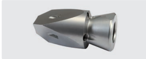
350 bar. 1/4" IG. \square 50 mm, \varnothing = 25 mm, \boxplus 0,13 kg. Für Rohre > 30 mm. Seitliche Frontstrahlen 0,5 mm gebohrt.
