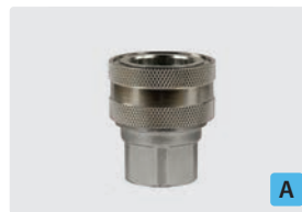
Kupplung : IG. Messing vernickelt. Max. 250 bar / 150 °C
