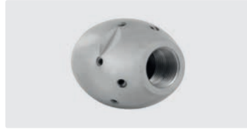
1/2" IG. 6x 75° 3x 30° +1x 0°. 80-140 l/min. Für \text{R} \varnothing 120-250 mm. Außen \varnothing 40 mm. \text{G} 630 g.
