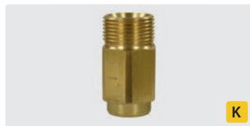
M22 AG : IG. Messing. Langbohrung. Max. 400 bar
