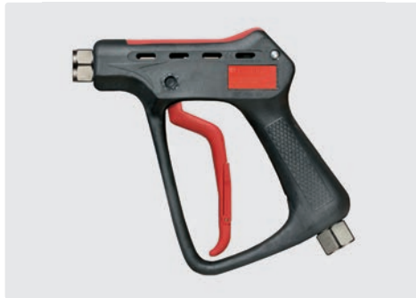
Professionelle Höchstdruckpistole. Max. 600 bar / 80 l/min / 150 °C
