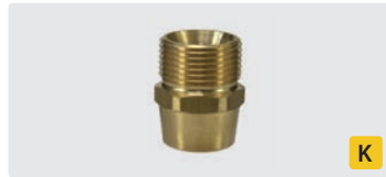
M22 AG : IG. Messing. Max. 400 bar
