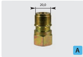
Stecknippel : IG. Stahl verzinkt. Max. 250 bar / 150 °C
