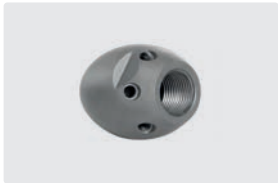
1/4" IG. 6x 75° +1x 0°. 20-50 l/min. Für \text{R} \varnothing 50-100 mm. Außen \varnothing 30 mm. \text{G} 127 g.
