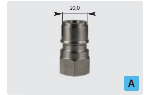
Stecknippel : IG. Edelstahl gehärtet. Max. 250 bar / 150 °C
