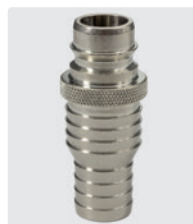
ST-45. Messing vernickelt. Stecknippel mit Schlauchtülle 19-25 mm. 25 bar / 90° C
