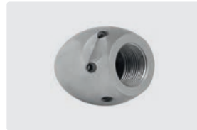
1/2" IG. 6x 75° +1x 0°. 30-100 l/min. Für \text{R} \varnothing 100-200 mm. Außen \varnothing 40 mm. \text{G} 281 g.
