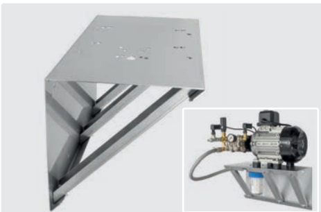
Edelstahl. 270 x 270 x 500 mm. Tragkraft: 80 kg. Passend für unsere Motorpumpenkombinationen mit 3 / 4 / 5,5 und 7,5 KW
