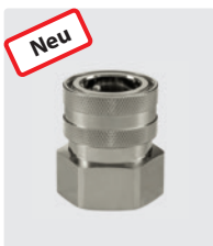
ST-45. Messing vernickelt. Kupplung : 1" IG. 25 bar / 90° C
