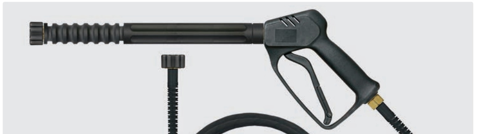
Pistole mit Verlängerung 340 mm, max. 210 bar / 25 l/min / 150 °C. Eingang / Ausgang HV M22. Schlauch: 6 - 160 mit 1 Gewebeeinlage, max. 160 bar / 20 °C
