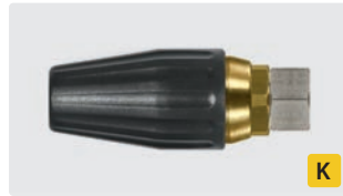
M18 IG. Spritzwinkel 20°. 100 - 250 bar. Max. 100 °C
