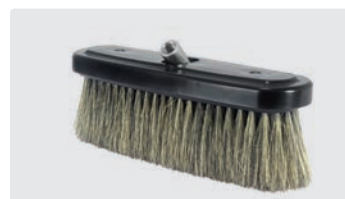
A= 260. B= 230 x 80 mm. Schweineborsten. Mit Trägerplatte Edelstahl. Max. 50 °C
