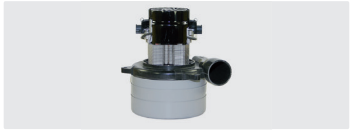
3-stufig mit Abluftrohr. Kabel vorinstalliert. 262 064 113 : 24 V. 262 074 113 : 36 V
